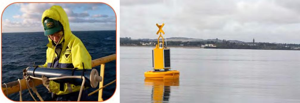
**Figura 1.5:** Sistemas de boyas para monitoreo con acústica pasiva. a) T-Pod b) PAMBuoy.
